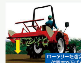
ロータリーを止め、地面にすらない位置まで下げ、重心を低くする
